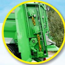
Antrieb über Getriebe
